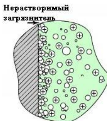
Рисунок 4 – Насыщение кавитационных пузырьков у загрязнения
