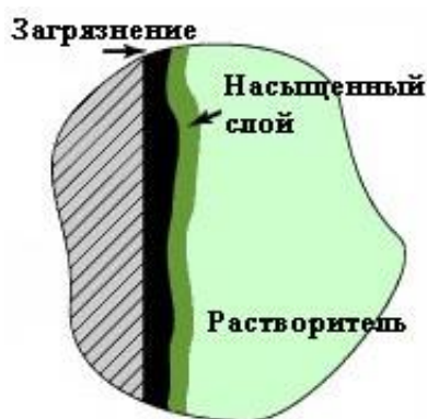
Рисунок 2 – Принцип химической очистки детали от загрязнения
