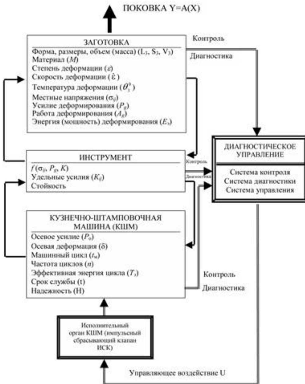
Рисунок 1 – Взаимозависимость математических моделей системы «КШМ – инструмент – заготовка – диагностическое управление – исполнительный орган КШМ»
