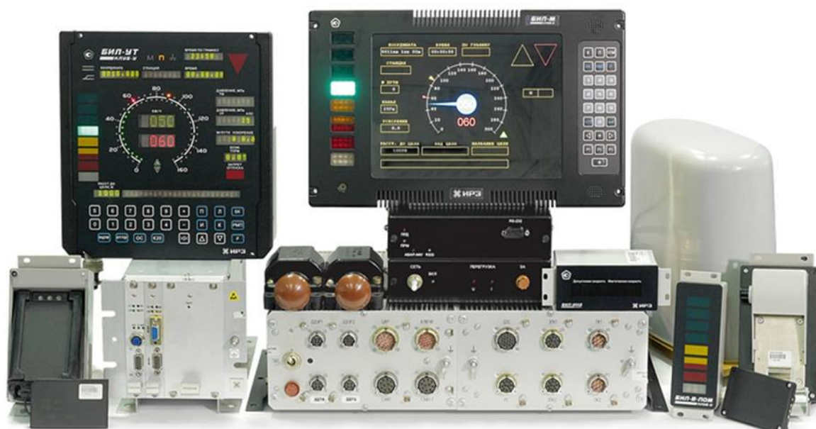
Рисунок 1 – Компоненты комплексного локомотивного устройства безопасности
