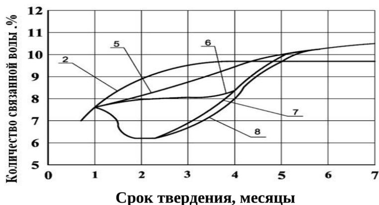
Рисунок 5 – Кинетика изменения количества прочносвязанной воды в белитовом цементном камне в процессе твердения при различных температурах, где 2 – постоянно в нормальных условиях, 5, 6, 7 и 8 – в начале один месяц в нормальных условиях, затем три месяца при температурах +5, 0, -5 и -10 °С и опять в нормальных условиях.
