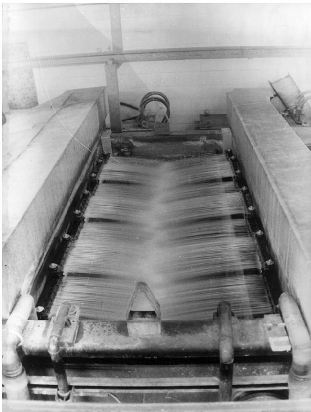
Рисунок 5 – Промывки деталей размещаемых на подвесках в ванне
