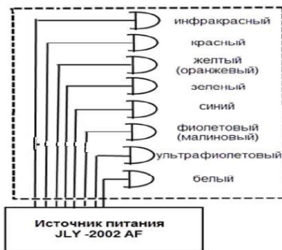
Рисунок 2 – Структурная схема подключения различных видов подсветки
