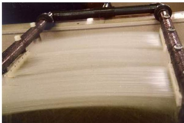
Рисунок 6 – В режиме рекуперации струй моющей жидкости
