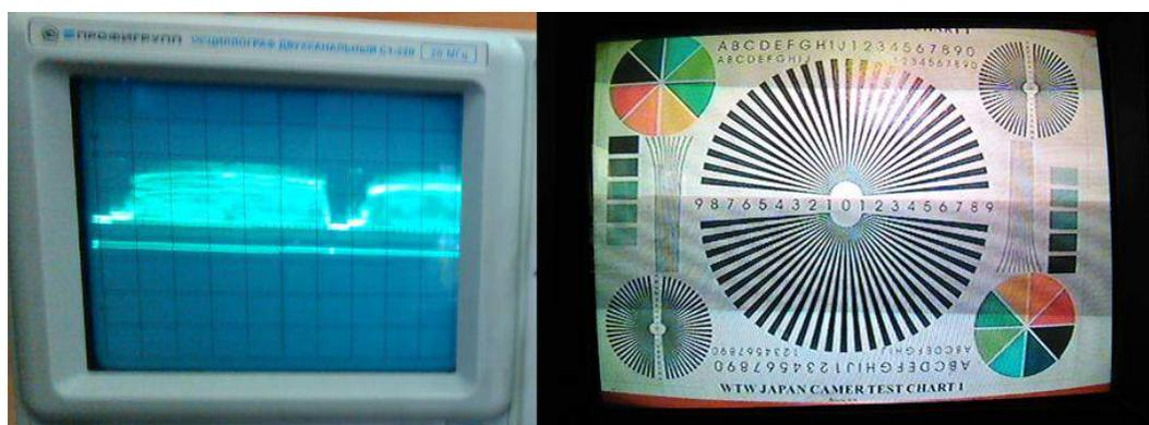
Рисунок 9 – Уровень выходного сигнала и изображение тестовой таблицы с видеомонитора, полученные при использовании цветной видеокамеры TAT-603S, 420 ТВЛ при освещении RGB светодиодами
