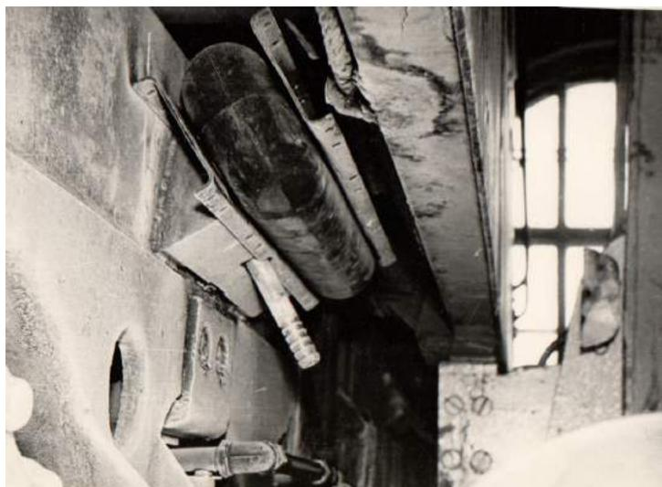
Рисунок 2 – Установка пневмоэлемента между кузовом и тележками
