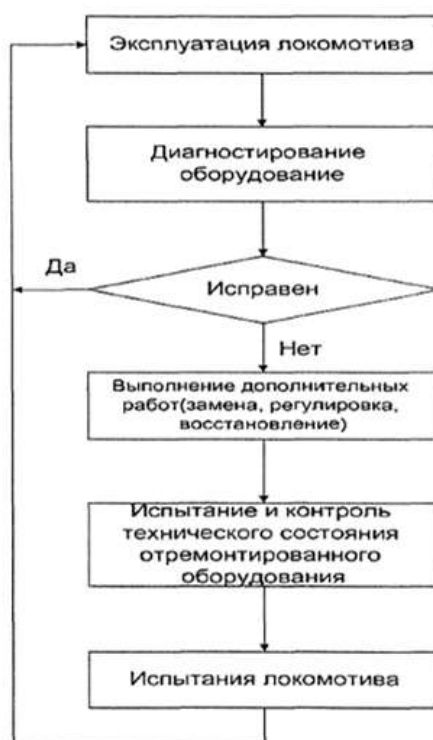
Рисунок 1 – Схема технического обслуживания и ремонта локомотивов по фактическому состоянию
