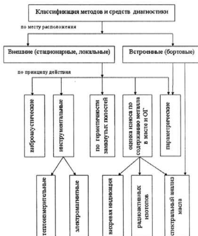
Рисунок 3 – Классификация методов диагностирования тепловозных дизелей
