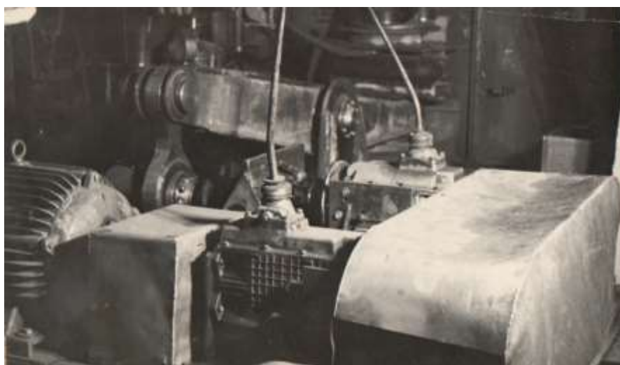
Рисунок 3 – Стенд для определения динамических характеристик пневмосистемы
