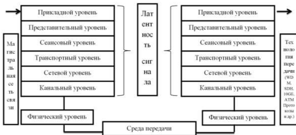
Рисунок 1 – Декомпозиция сквозной задержки и место в ней магистральной сети
