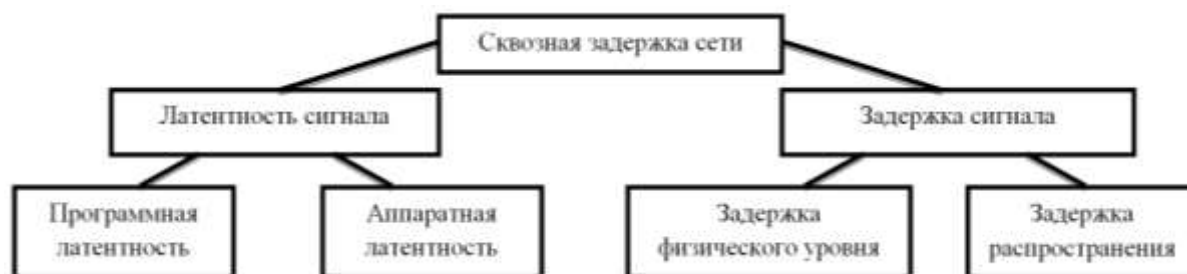
Рисунок 2 – Четыре слагаемых сквозной задержки
