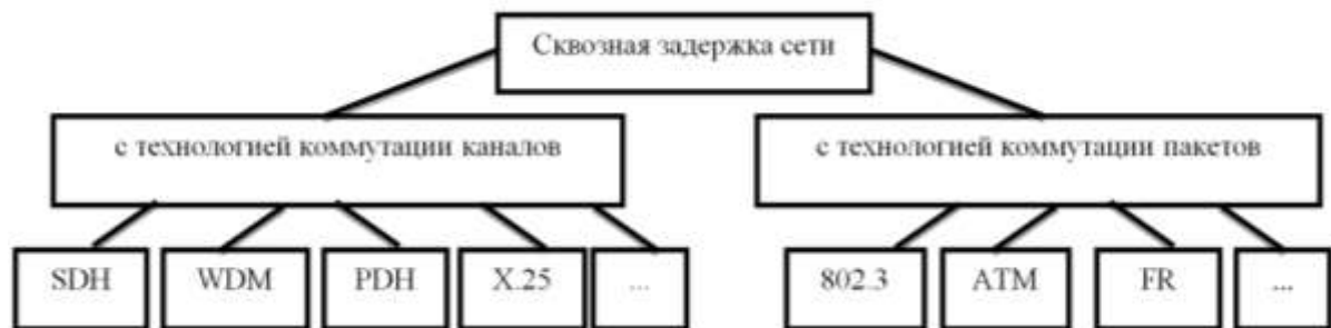
Рисунок 3 – Классификация участков сети с различными технологиями коммутации
