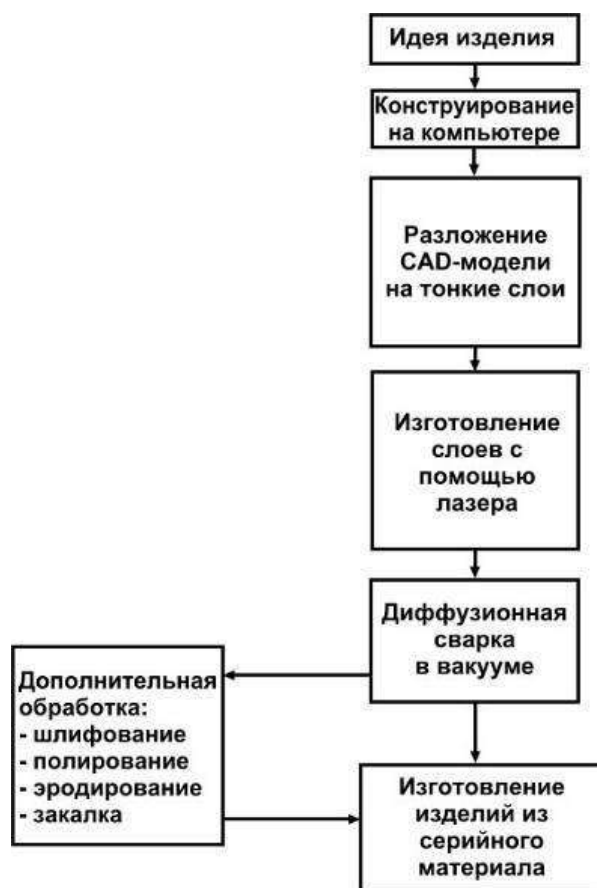
Рисунок 4 – Алгоритм создания пресс-форм из листовых порошковых материалов
