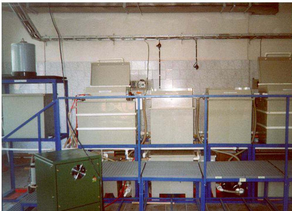
Фото 1 – Выполненный в двухуровневой компоновке ОМ бессточной гальванохимической деталей на подвесках (в данном случае – электрохимического обезжиривания) с устройствами для подготовки и накопления дистиллированной воды (г. С.-Петербург)
