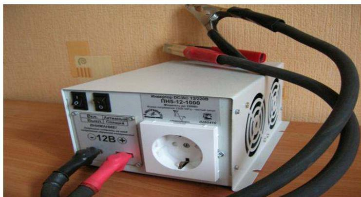
Рисунок 1 – Инвертор 12DC- 220AC, 1000W
