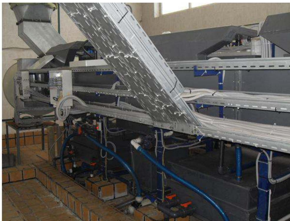
Фото 3 – Выполненный в двухуровневой компоновке ОМ бессточного хромирования деталей, размещаемых на подвесках. (Гальванический цех, г. Заречный, Пензенской обл.), вид сбоку
