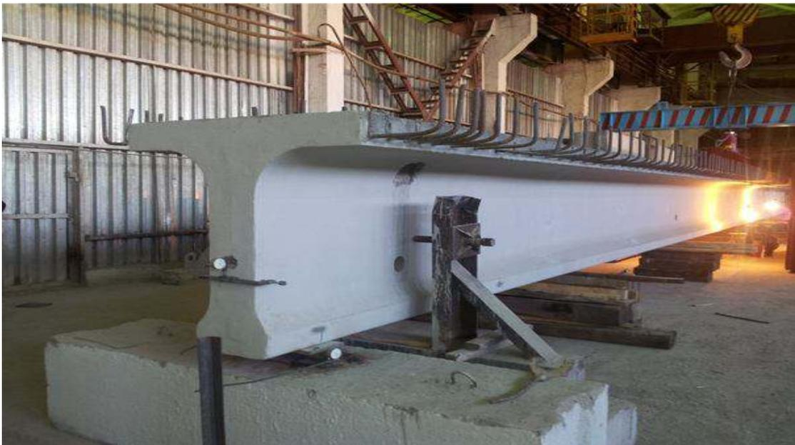
Рисунок 8 – Опорная зона балки с индикаторами часового типа
