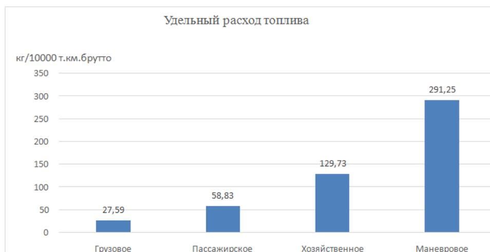
Рисунок 1 – Удельный расход топлива тепловозами по видам движения
