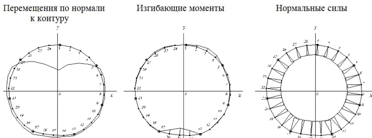
Рисунок 3 – Результаты расчета кольца обделки при основном сочетании действия нагрузки
